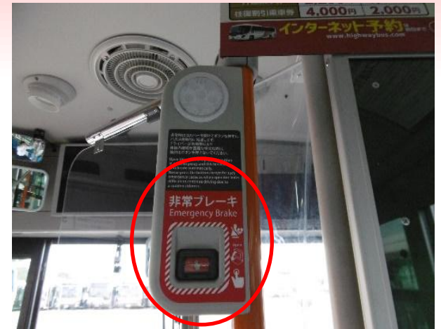
非常押しボタン
